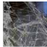
Verbundsicherheitsglas Durch transparente Folien zwischen den Scheiben sind VSG-Gläser durchwurfhemmend.
